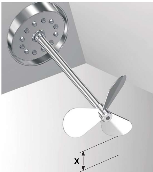
Rys. 7 Minimalna odległość łopatek wirnika od dna zbiornika
