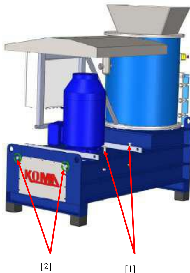
Rysunek9. Procedura wymiany i napinania pasów klinowych
